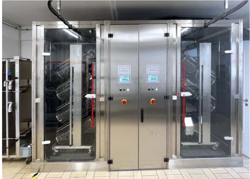
Vollautomatische Masken- und Lungenautomatenreinigung in der ZAW
