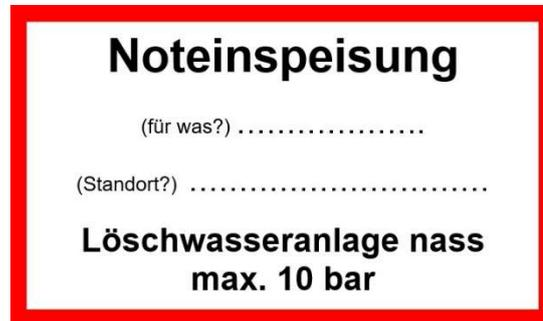
Kennzeichnung von Einspeisearmaturen von Wandhydrantenanlagen.
