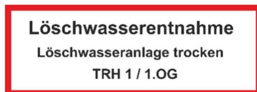
Kennzeichnung der Entnahmestelle bei Löschwasseranlagen „trocken“.
