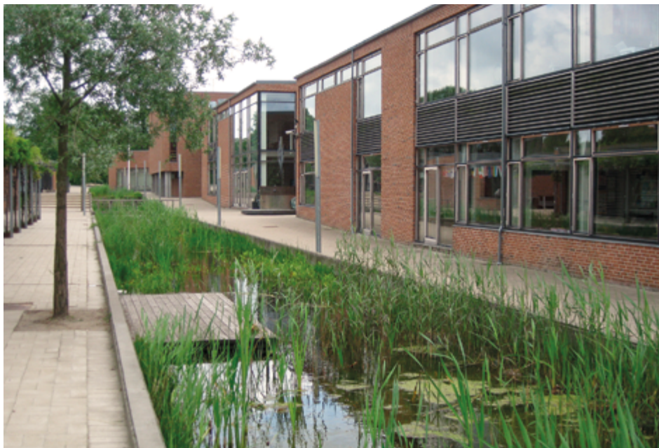
Abb. 73 (oben): Schutzmaßnahmen – wie hier in Kopenhagen eine kleine Teichrinne als Retentionsbecken – sollten bei Neubauten immer integriert werden. Abb. 74 (unten): Große Wasserkanäle in Wohngebieten sind nicht nur Schutz, sondern auch ökologische Naherholung.
