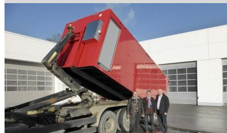
Absetzen des Abrollbehälters ist Teil der Baumusterprüfung
